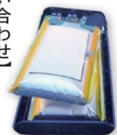
膨らんで変形した、モバイルバッテリーのリチウムイオン電池
