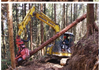
1_藤岡社長のアドバイスを受けながらチェーンソーの使い方を練習する宮内さん 2_中田さんは丸太を積み込むグラブの操作を練習 3_高性能林業機械ハーベスタ。伐倒、枝払い、玉切り、集積を一台で行う
