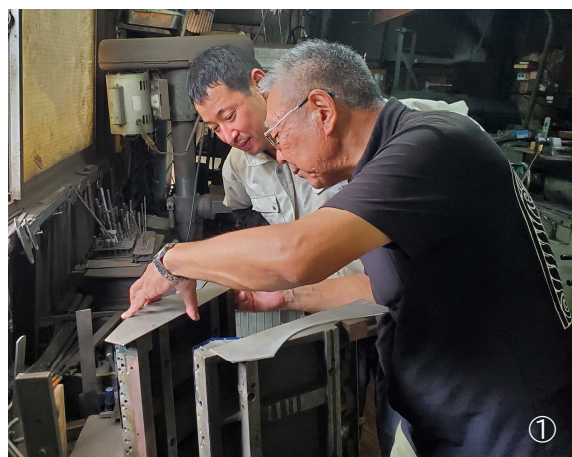
棧瓦用金型製作の様子(8 月 27 日撮影)
