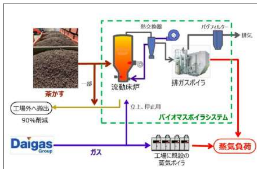
図 2-49：「D-Bio Steam」の仕組み（出典 スマートジャパンWEBメディア記事）
