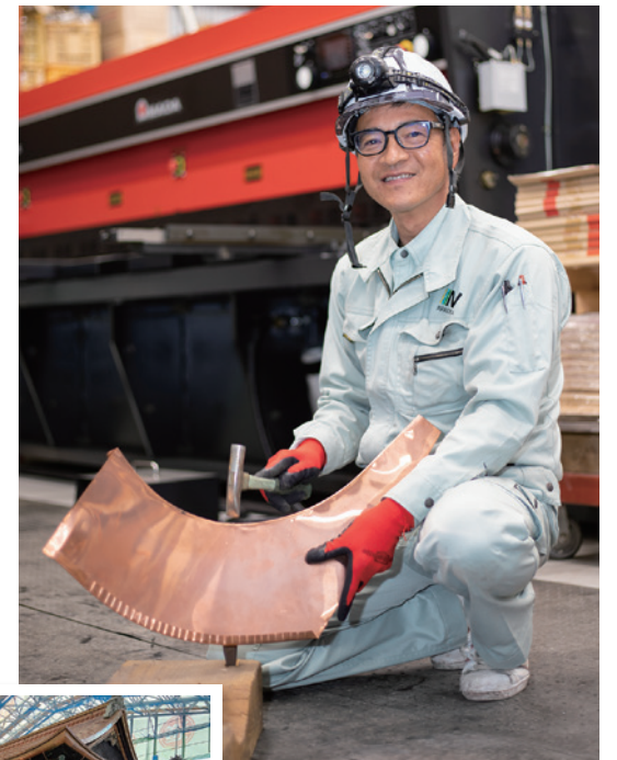
上_金づちでたたいて、銅板を加工する成岡さん 左_葺き替え工事で、あかがね色に輝く銅板屋根
